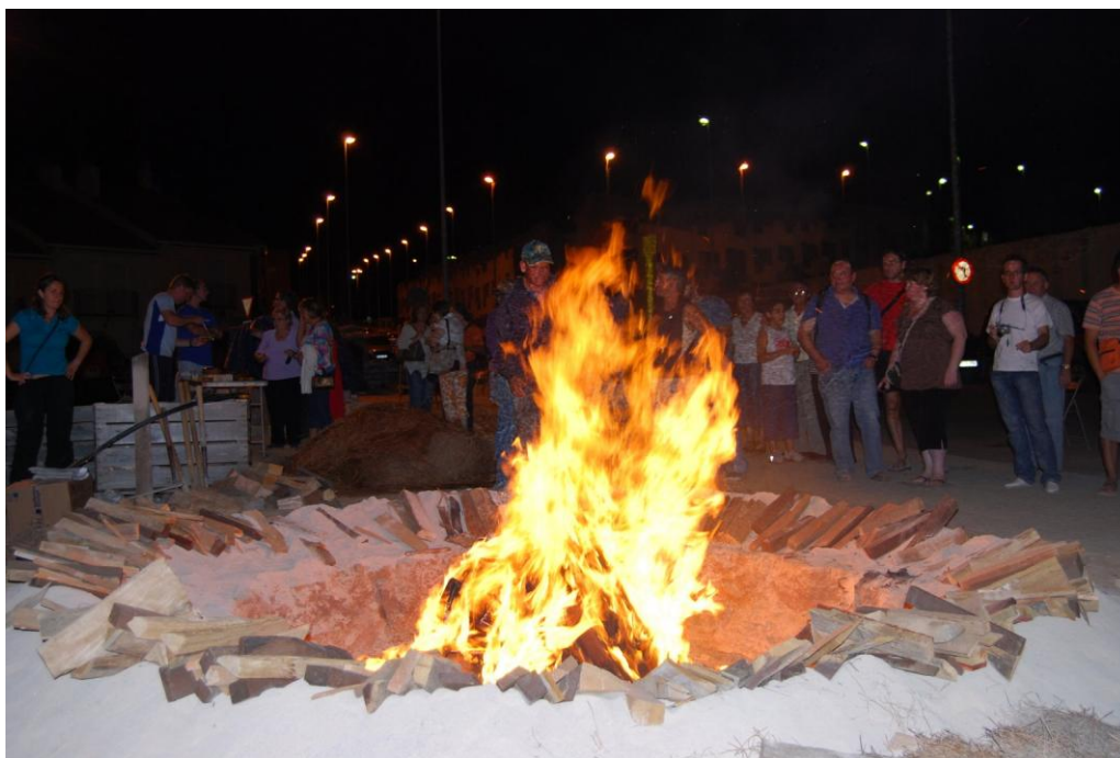
Depois rodeou-se todo o conjunto com cavacas; o monte ardia e o lume ia cozendo o barro.
