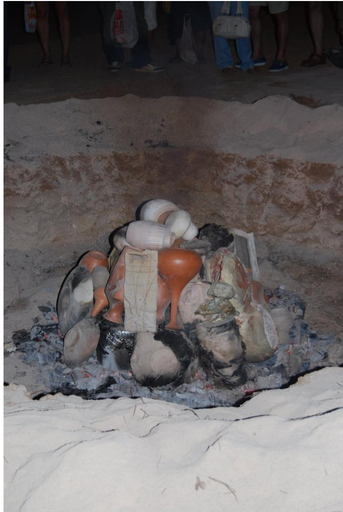
Ao fim de bastante tempo, já as peças estavam suficientemente quentes e havia bastantes brasas. Colocaram-se, então, as peças umas em cima das outras, no centro da soenga.
